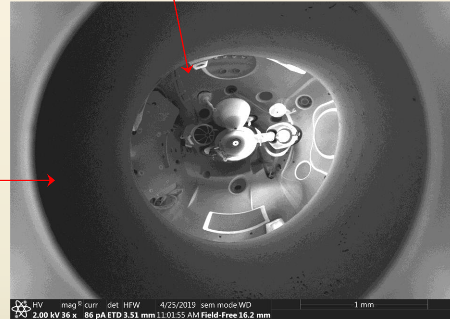
Image électronique de la chambre du FIB reflétée par le morceau de téflon
