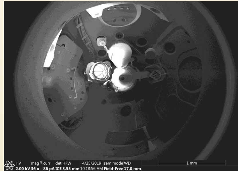
Détecteur ICE (In-Chamber Electronics)
